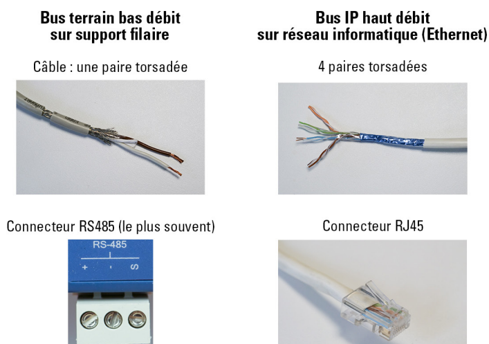
Figure 15 : Les types de câbles et de connecteurs des bus filaires (TP) et IP.
